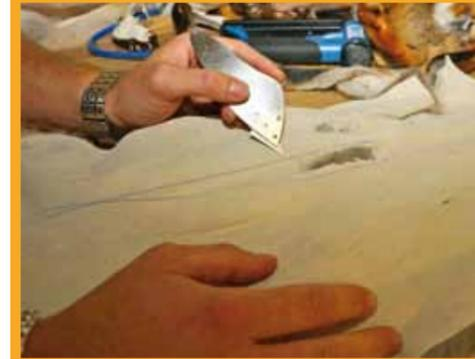
Große Schadstellen werden z. B. durch das „Zungenziehen“ geschlossen. Die Zunge hat die Form eines spitzwinkligen Dreiecks.
