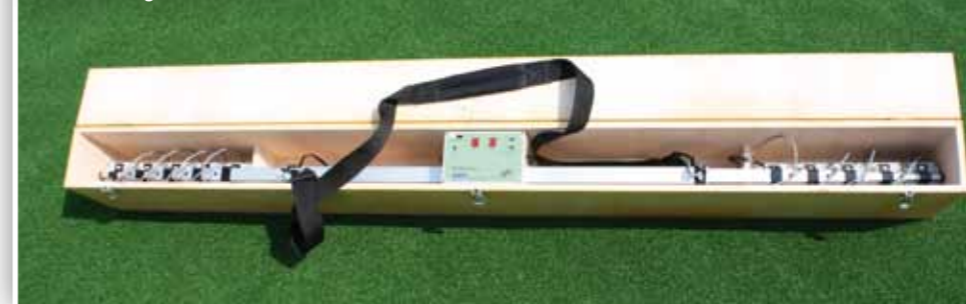
Der tragbare Detektor mit den an Teleskoparmen befestigten Infrarotsensoren.
