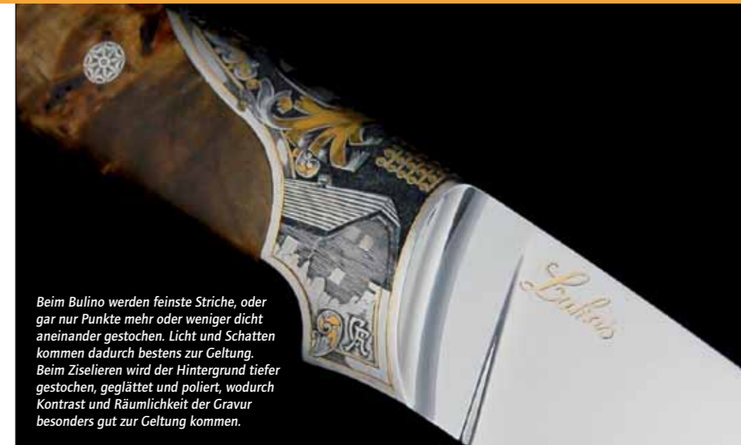
Um Gold oder Silber einlegen zu können, muss vorher Material abgetragen werden. In die gestochenen Linien wird das Edelmetall anschließend eingesetzt.
