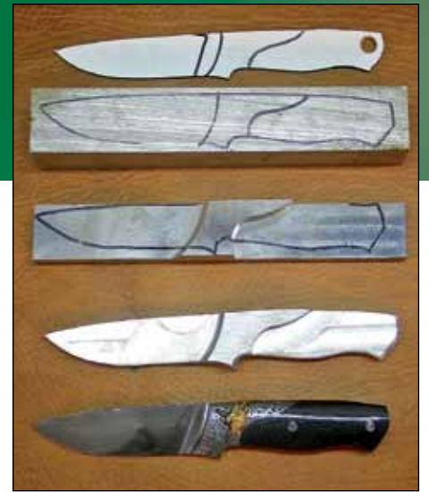
Von der Skizze bis zur Komplettierung entsteht das handgefertigte Messer in vielen einzelnen Entwicklungsschritten.
