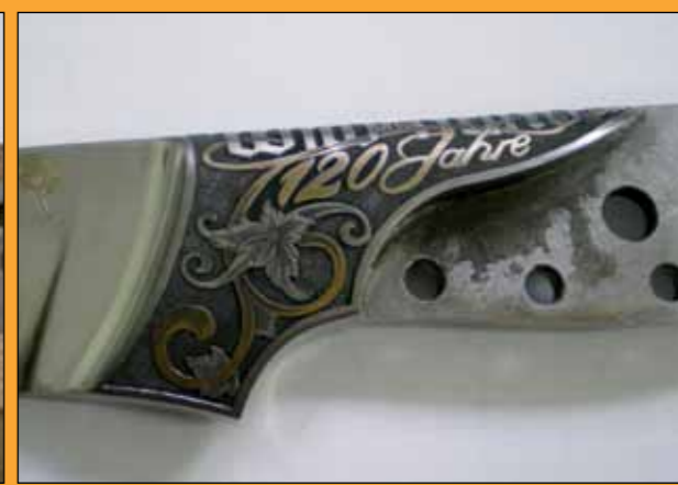
Neben dem Flachstich, der meist verwendeten Gravurtechnik, kommen auch der Bulino und das Ziselieren zum Einsatz.
