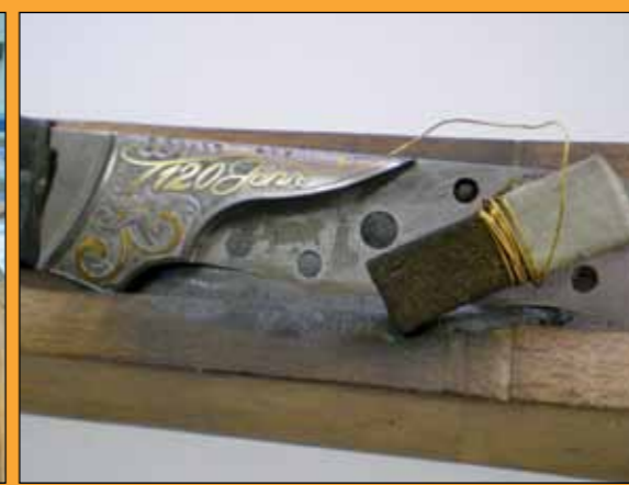
Um Gold oder Silber einlegen zu können, muss vorher Material abgetragen werden. In die gestochenen Linien wird das Edelmetall anschließend eingesetzt.
