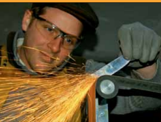
Nach dem Ausschneiden wird der Messerrohling entgratet.
