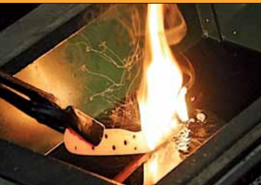
Nach dem Erhitzen wird der Rohling in einem Ölbad abgeschreckt. Das Material gewinnt dadurch an Härte, Schmitthaltigkeit und Belastbarkeit.
